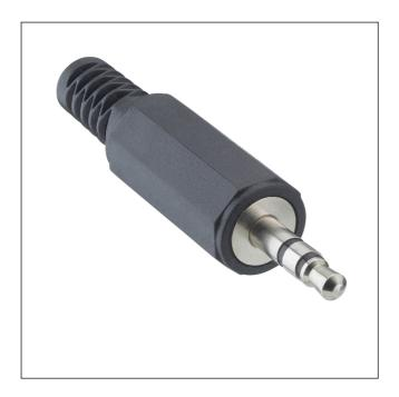
Klinkenstecker nach JIS C 6560 JC35P3, 3,5 mm, 3-polig/ stereo, gerade Ausführung, mit Knickschutz und Lötanschlüssen
